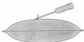
Leválás okozta károsodás
