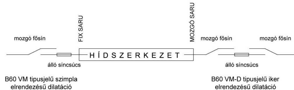
4.62. ábra B60 VM rendszerű, nagy nyitású dilatációs szerkezetek elvi elrendezése
