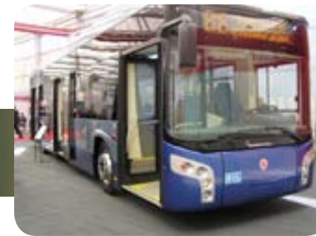
A nemzetközi kínálatból kiemelhető olasz BredaMenarinBus midibusza tisztán elektromos hajtásrendszerrel is elérhető.
