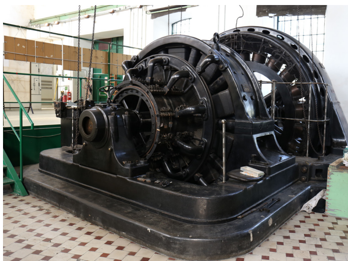
Ferenc áramátalakító motordinamó 1912
